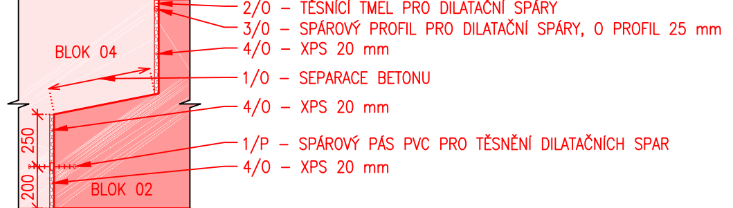
DETAIL "C", MĚŘITKO 1:25 DILATAČNÍ SPÁRA VE DNE K BLOKU PŘELMÉ HRANY
